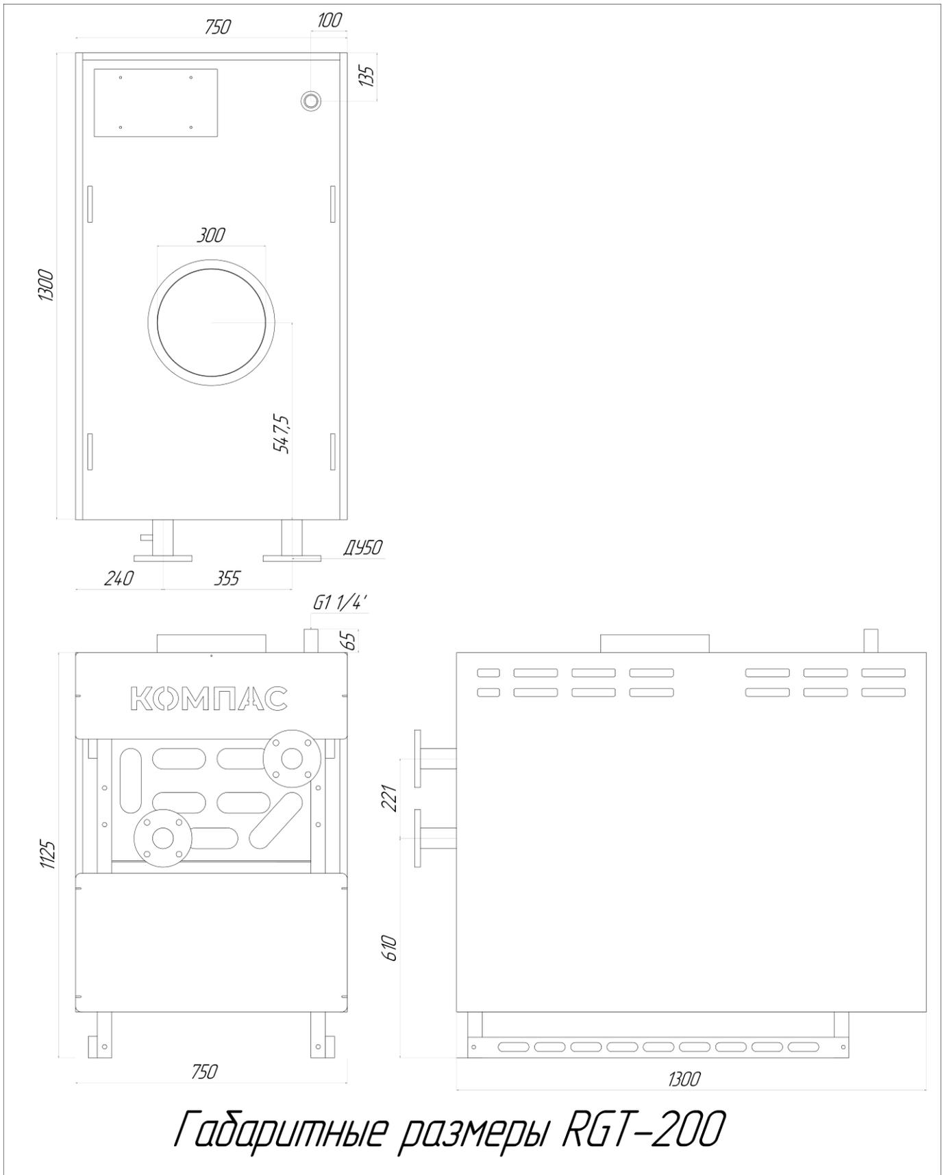
Рисунок 5 – Габаритные размеры RGT-200
