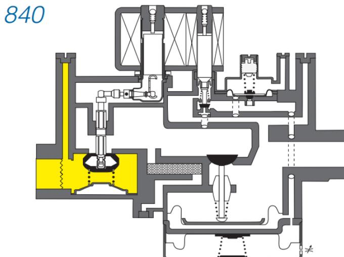
Рисунок 14 – Устройство клапана в разрезе
