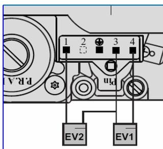
Отключение. Отключается напряжение 220 вольт от соленоида EV1 (выполняющего функцию клапана безопасности).
