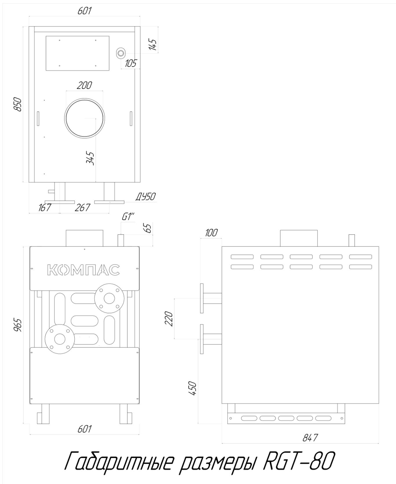
Рисунок 1 – Габаритные размеры RGT-80
