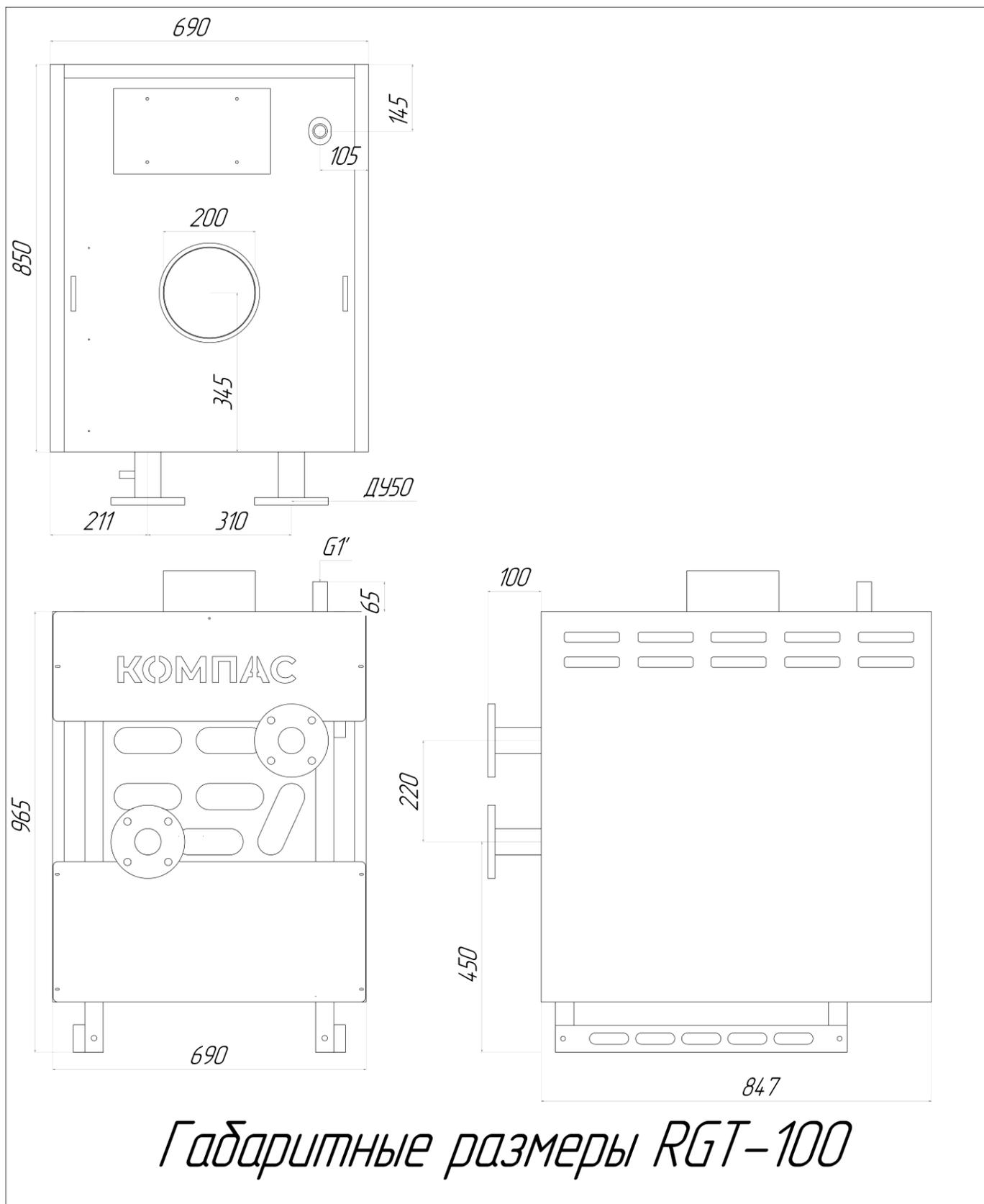
Рисунок 2 – Габаритные размеры RGT-100
