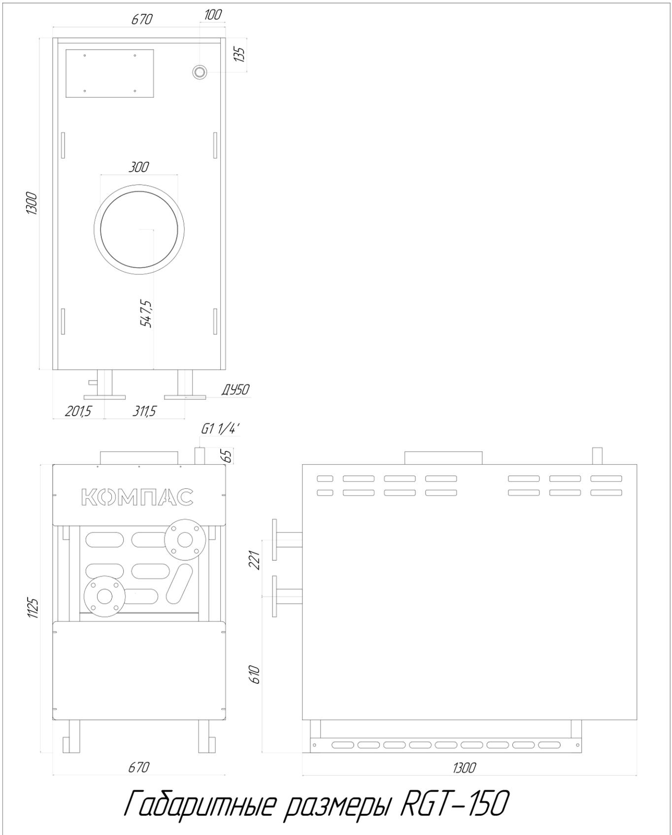
Рисунок 4 – Габаритные размеры RGT-150
