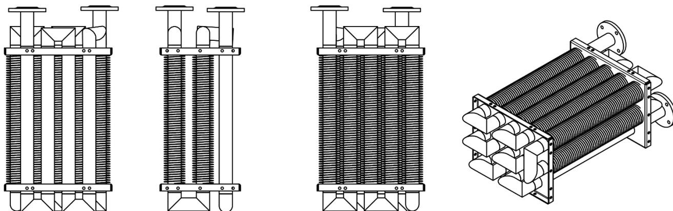
Рисунок 6 – Схематическое устройство теплообменника
