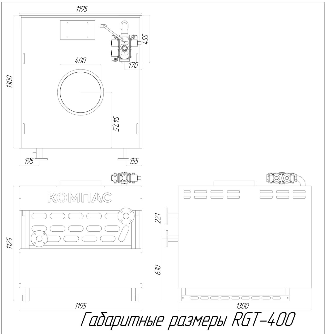
Рисунок 3 – Габаритные размеры RGT-400
